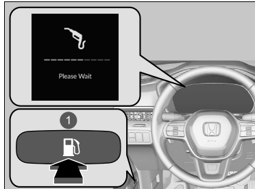
1 Butonul de deschidere a ușii rezervorului
