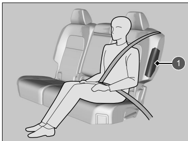
1 Amplasarea airbagului lateral
